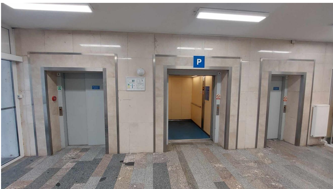
Fotografie stávajícího stavu - výtahová hala v přízemí. Jedná se o fotografii protější strany výtahové haly. Nový stav obkladů a lišt po realizaci výměny výtahů č. 7 a 9 musí být totožný ve všech patrech jako stávající řešení viditelné na této fotografii..
